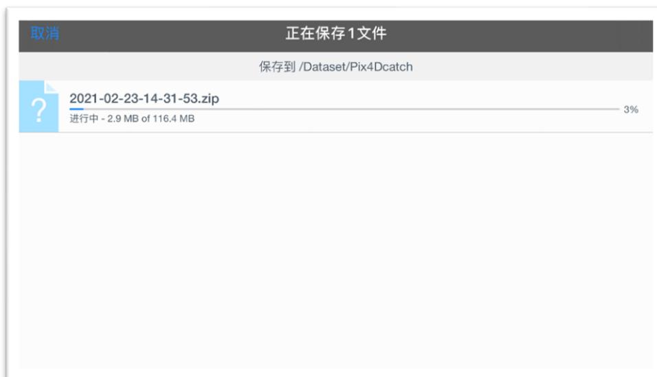
7) 项目将被保存为压缩文件。下载文件，然后使用解压缩软件（例如 7-Zip）将其提取，就可以导入到 Pix4Dmapper 中进行处理。
